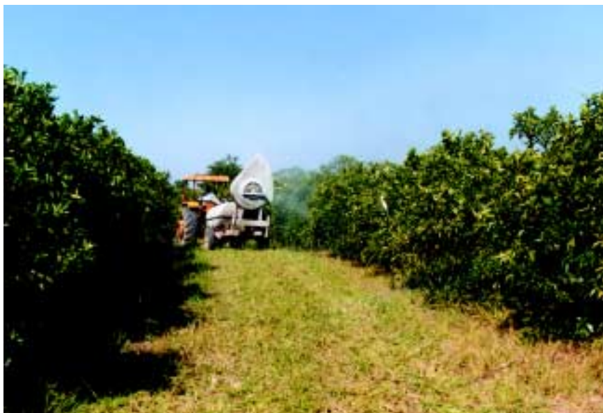
Figura 5. Pulverização de Beauveria bassiana em pomar de laranja “Pera”, utilizando-se atomizador tratorizado
